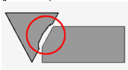
unkontrollierte und unlineare Abnutzung (nicht zu kompensieren)
